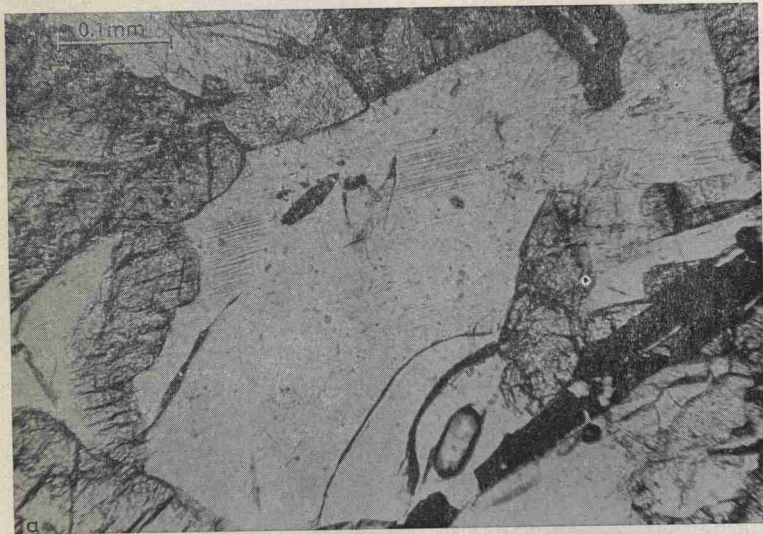
Abb. 5. Plagioklas mit feinen durch Stoßwellen erzeugten Deformationslamellen. Mikroskopisches Bild eines Korns aus dem Mondboden, gekreuzte Polarisatoren. Die dünnen Lamellen haben keine oder eine nur geringe Doppelbrechung.
